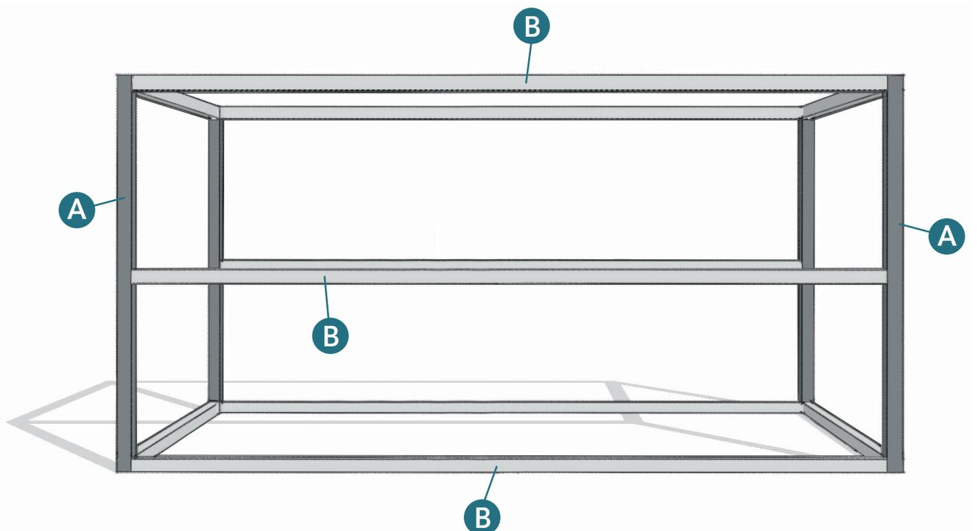
Si compone di due tipi differenti di profilo 15x15. Il profilo A (pieno) è usato nelle situazioni in cui si vogliono vedere gli elementi perfettamente finiti e allineati con il profilo B (cavo), che consente invece l'alloggiamento delle giunzioni.
