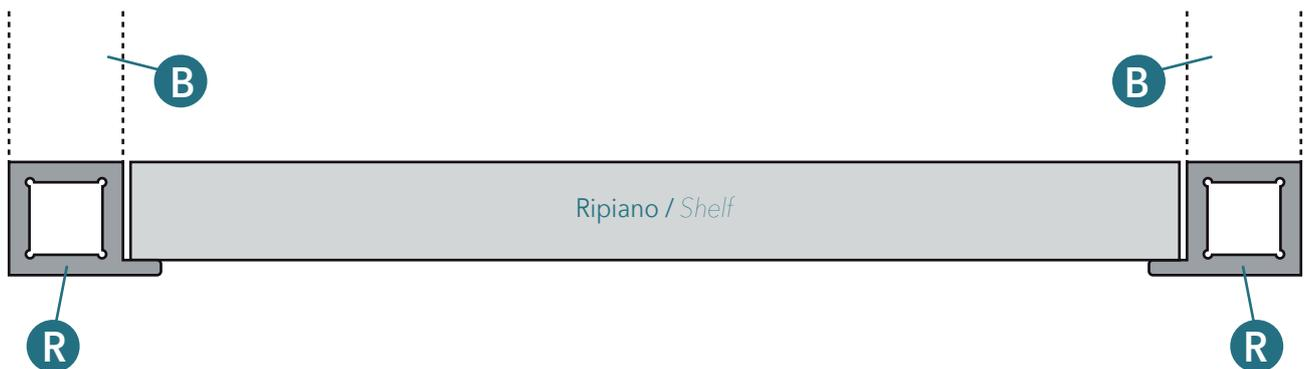
In opzione al profilo B (cavo) si può usare il profilo "R" per sostenere i vari ripiano della composizione, dando perfetta linearità e praticità d'uso alla struttura.
