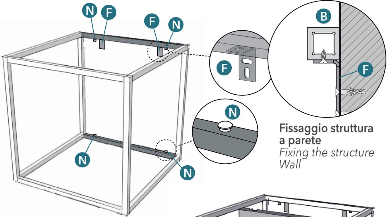
**Fissaggio struttura a parete**
