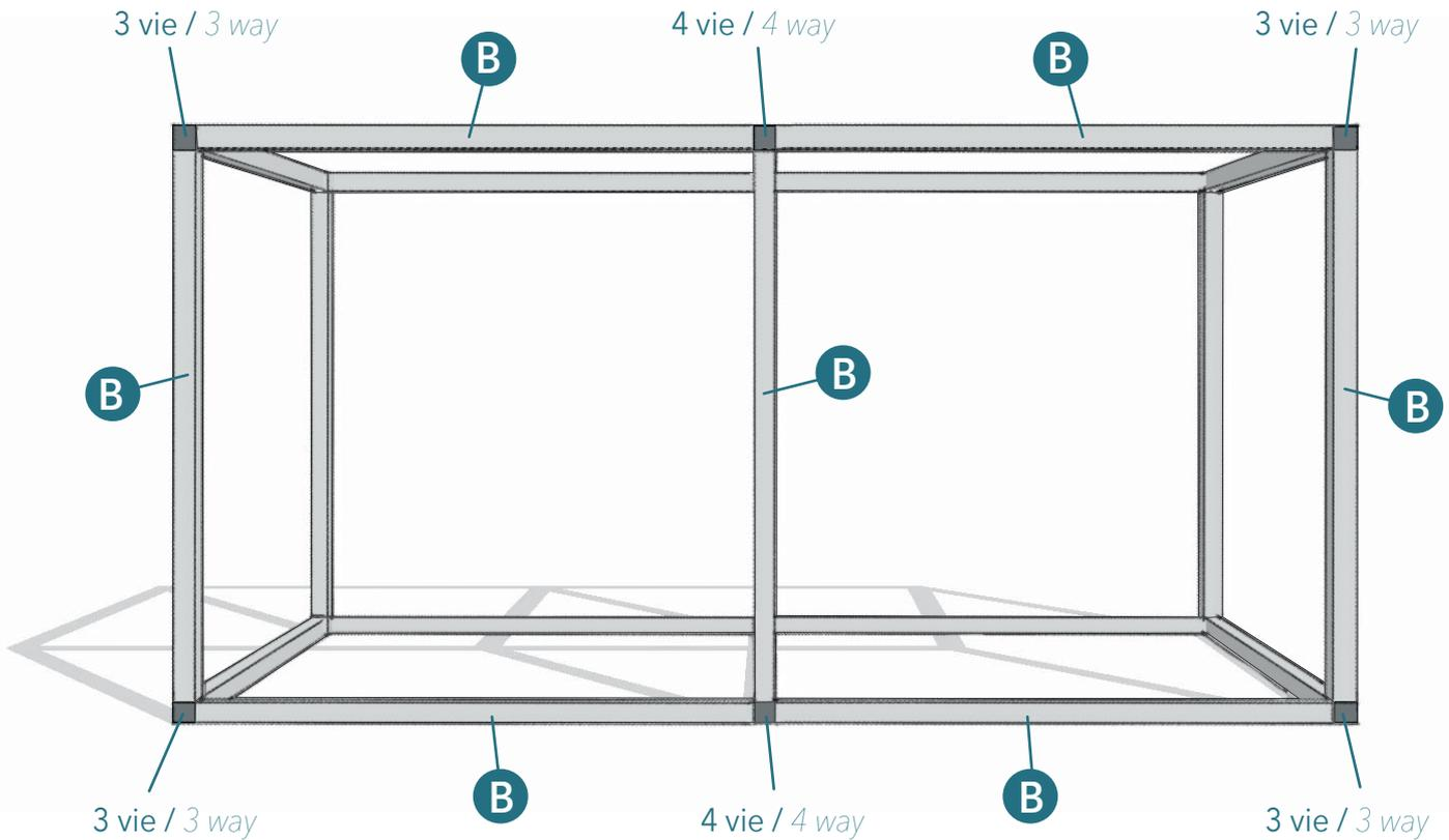
E' composto da un unico profilo B (cavo) 15x15. Le varie parti vengono unite con i tue tipi di giunzioni a 3 vie o a 4 vie. Queste giunzioni permettono di ottenere qualsivoglia struttura. Tutto è fissato con un semplice grano M5 su ogni braccio della giunzione. Massima praticità nel montaggio ed elasticità d'impiego.
